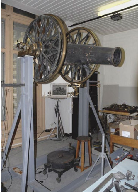
Figure 3 : Cercle méridien d'Eichens datant de 1876, démonté en 1913 et en cours de remontage par Jim Caplan et Paolo Brenni à l'Observatoire de Marseille. © J. Caplan
