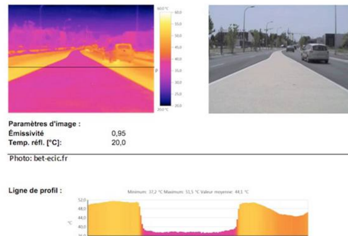
Figure 2. Variation des températures de surface suivant les matériaux et leurs couleurs : près de 12°C d'écart entre les deux couleurs d'enrobés ... Source : ECIC 2014 ( http://bet-ecic.fr/ladaptation-au-changement-climatique-et-le-phenomene-d-ilot-de-chaleur-urbain-consequences-sur-les-batiments/ ).
