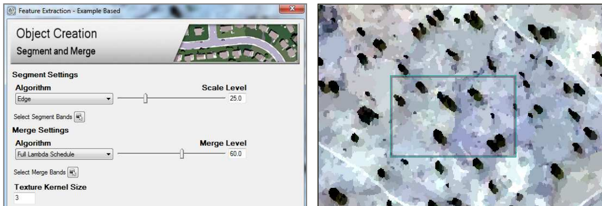
Figure 7 : Aperçu du processus de segmentation de l'image Spot avec la pseudo-bande NDVI
